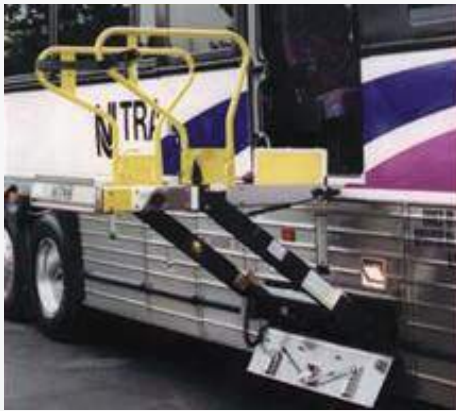
شكل ١٢٦: مصعد يمكن تخزينه بعد الاستعمال
