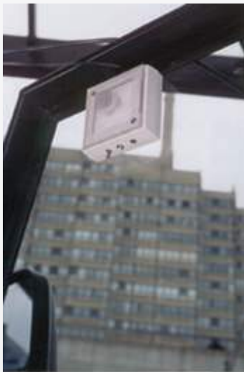
شكل ١٢١: أجهزة بث واستقبال للإشارات الصوتية المرسله عن بعد بواسطة الأشعة تحت الحمراء
