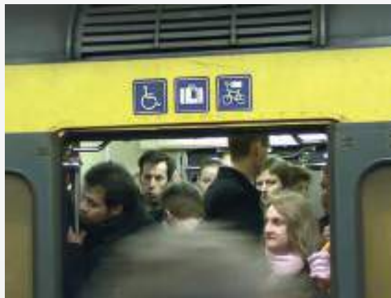
شكل ٩٨: باب متسع كفاية لدخول راكب على كرسي متحرك أو دراجة أو الأمتعة الكبيرة، باب مجهز لتسهيل الوصول في محطة أنفاق
