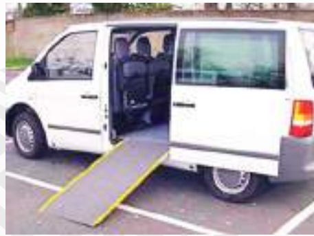
شكل ٥٣: سيارة أجرة من نوع فان مزودة بسطحه عند المدخل الجانبي لإركاب مستخدمي الكراسي المتحركة
