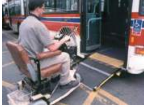
شكل ٦٦: راكب على عربة كهربائية يحاول الصعود من الشارع إلى حافلة منخفضة الأرضية بواسطة منحدر مثبت إلى الباب الأمامي
