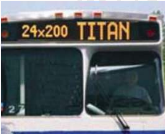
شكل ٤٢: المعلومات الخاصة بالمقصد او المسار معروضة على الوجهة الخارجية للمركبة، لافتة ثنائي باعث الضوء (LED) بخط كبير و تباين لوني
