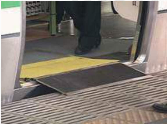
شكل ١١١: سطحة يدوية الاستخدام لتجسير الهوة بين المركبة والمنصة
