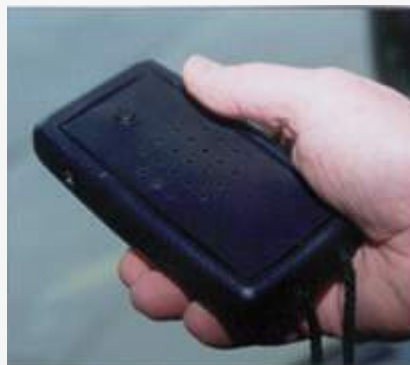
شكل ١٢١: أجهزة بث واستقبال للإشارات الصوتية المرسله عن بعد بواسطة الأشعة تحت الحمراء
