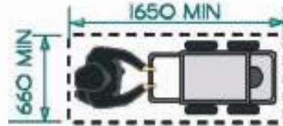
شكل رقم ٨: الفراغ المطلوب لشخص معه عربة أطفال /عربة يد نموذجية (انظر أيضا الأشكال ٢٦-٣١)
