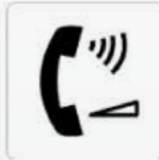
Figure 77 — Telephone amplification (ETSI) شكل ٧٧- التكبير بالهاتف (المعهد الأوروبي لمعايير الاتصالات عن بعد ETSI)
